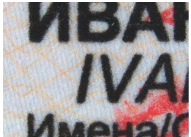
Teknik til integrering af persondata og foto: laserprint
