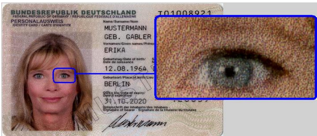
Integrering af foto i polycarbonatkortet (Innosec Fusion-proces)
