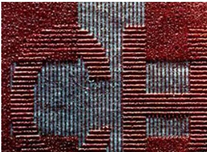
stregstruktur (90°) i latent billede
