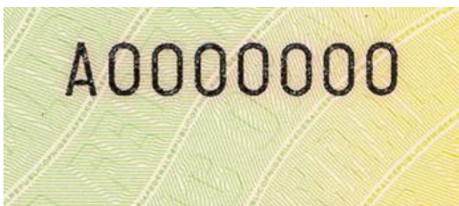
Serienummer trykt med opløselig trykfarve, der reagerer i rød (penetrerende blæk)
