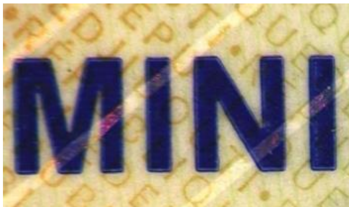
Flexotryk på laminat
