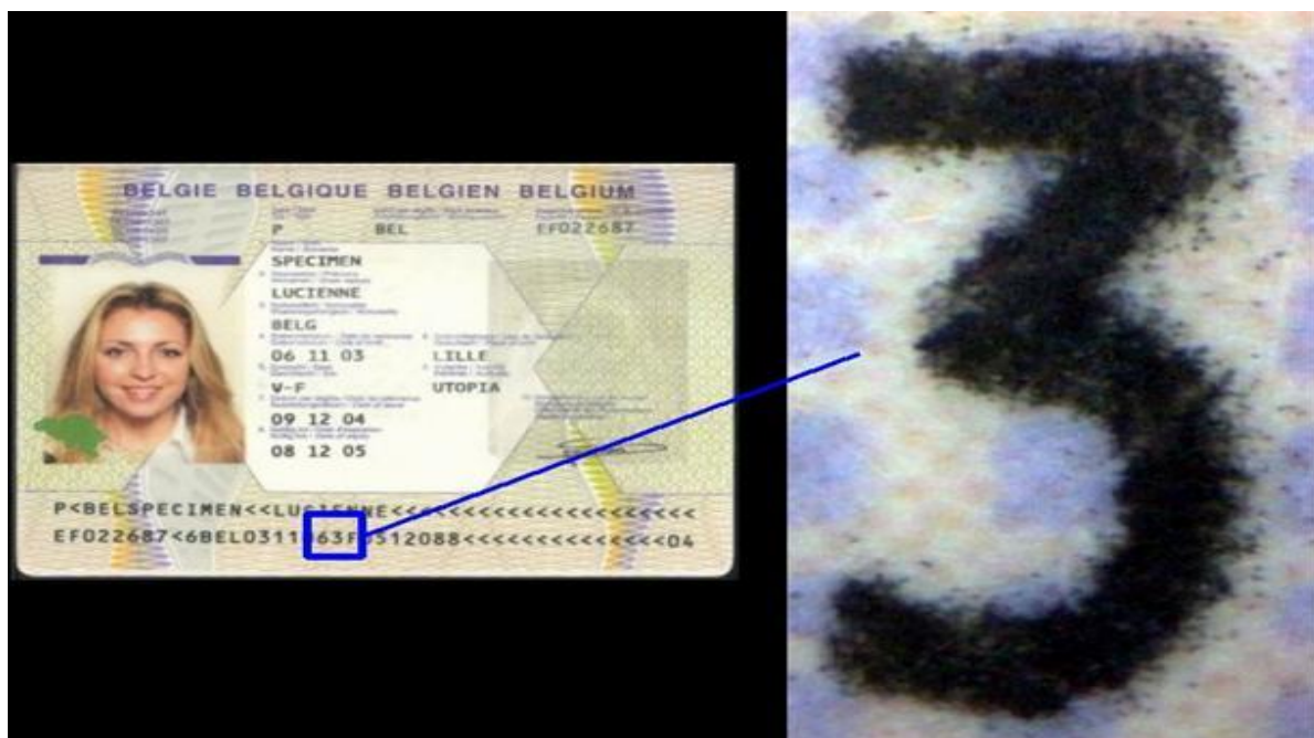
Integreringsteknik (MRZ): laserprint
