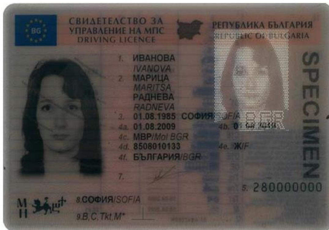
Laserperforeret sekundært billede (spøgelsesbillede)
