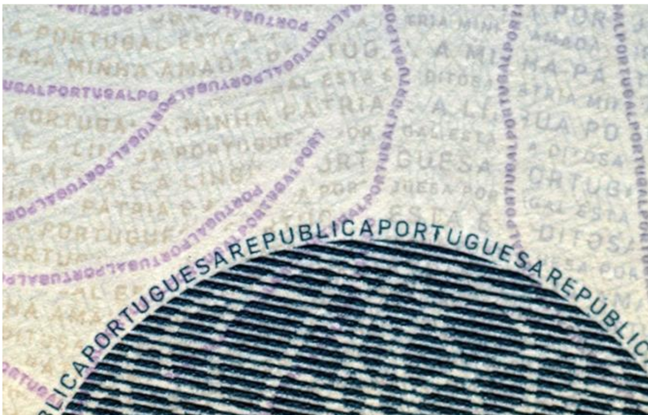
Minitryk (blå tekst) og mikrotryk (mindre rødviolette bogstaver)
