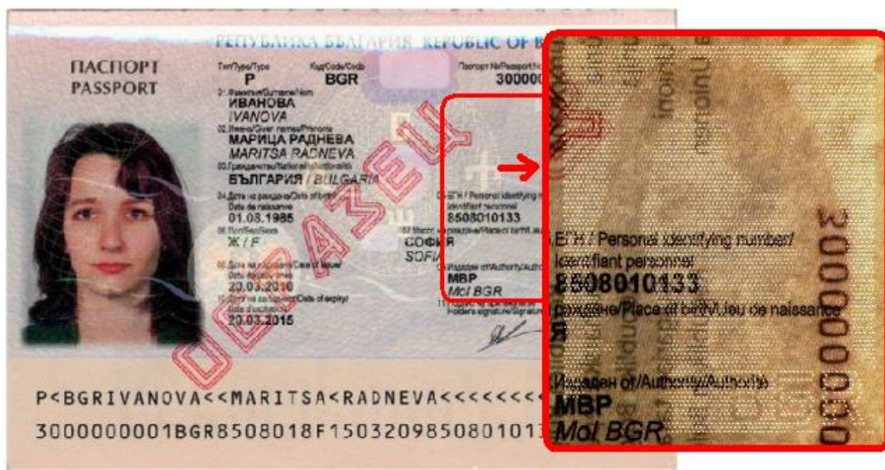
Laserperforeret sekundært foto (spøgelsesbillede) set ved gennemlysning (i højre side)
