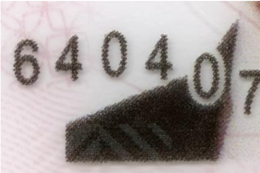
PCP® Technologie ("Polycarbonate Colour Personalisation" – Polycarbonat- Farbpersonalisierung)
