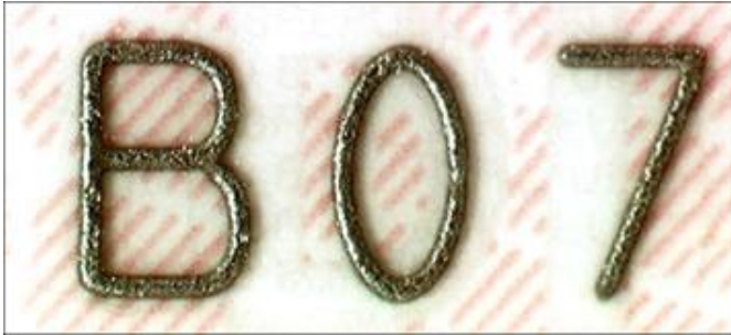
Fühlbare Lasergravur der Nummerierung
