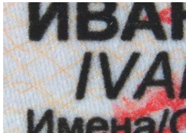
Integration von Personendaten und Lichtbild mittels Laserdruck
