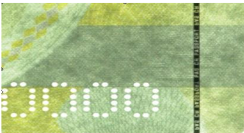
Sicherheitsfaden mit Negativ-Mikrodruck (im Durchlicht)
