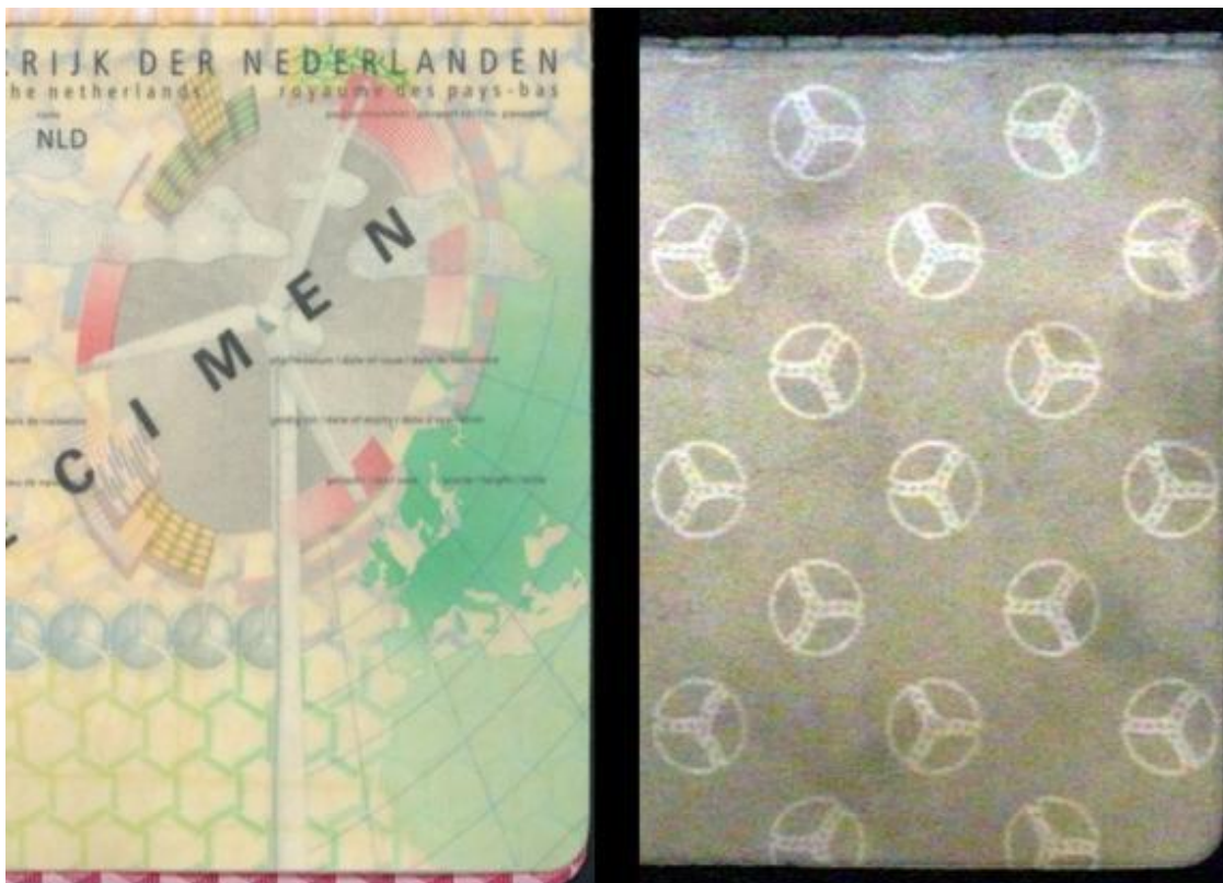
Normallicht (links) & Koaxiallicht aufnahme (rechts)
