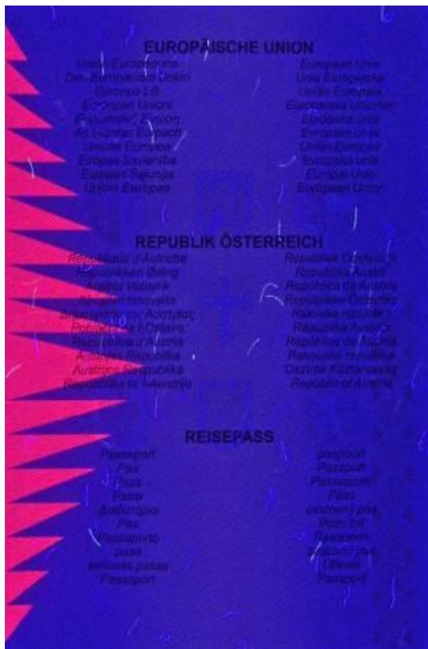
Bedruckstoff ohne optische Aufheller
