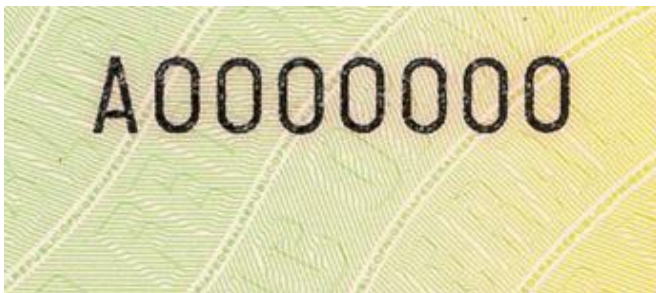
In ausblutender (durchdringender) Druckfarbe gedruckte Seriennummer
