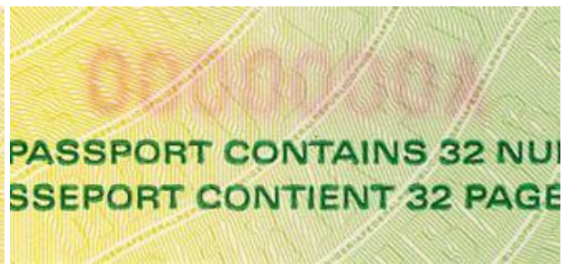
Druckfarbe für die Seriennummer ist teilweise durch den Bedruckstoff durchgeblutet und auf der Rückseite sichtbar.
