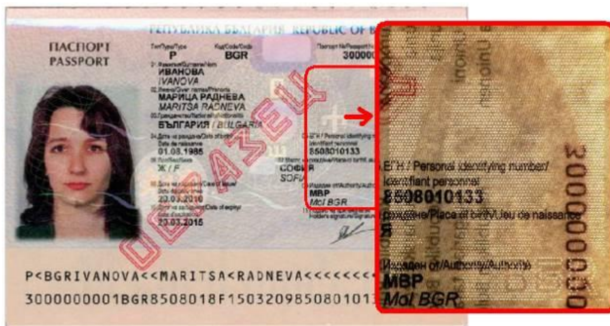
Laserperforiertes Sekundärlichtbild im Durchlicht (rechts)
