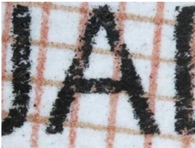
Integration der Personaldaten / des Lichtbildes mit dem Tintenstrahldruckverfahren
