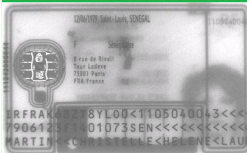
Der Kontaktchip und der kontaktlose Chip sowie die speziell geformte Rahmenantenne in der Polycarbonat-Karte sind im → Durchlicht sichtbar.
