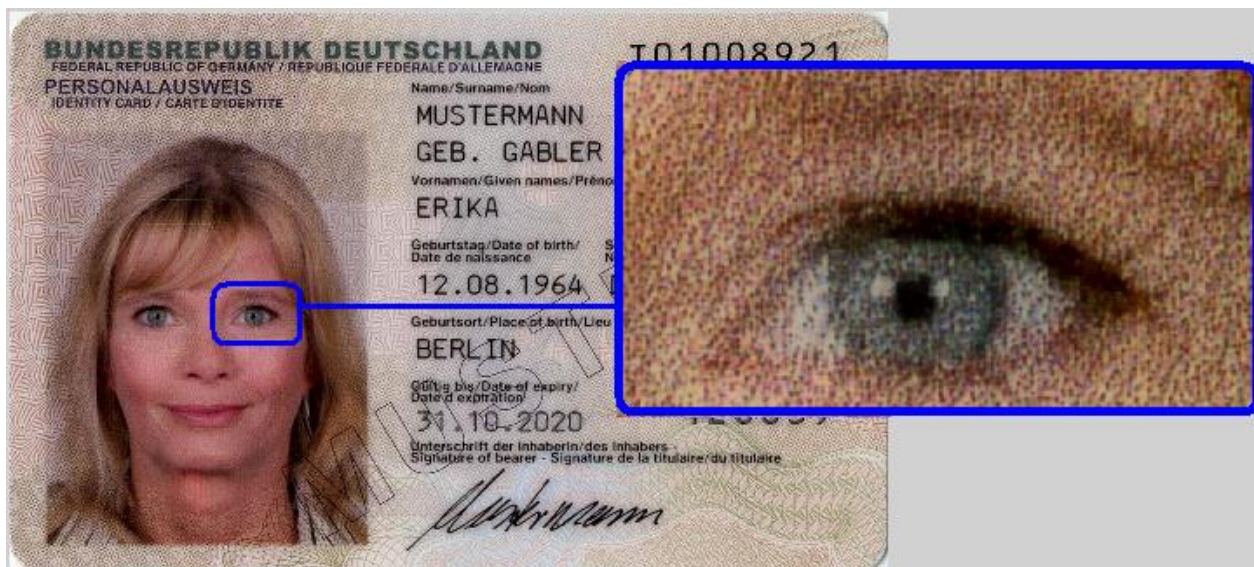
Intégration de la photo dans la carte en polycarbonate (procédé Innosec Fusion)
