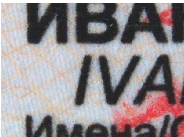
Procédé d'intégration des données biographiques et de la photo: impression laser
