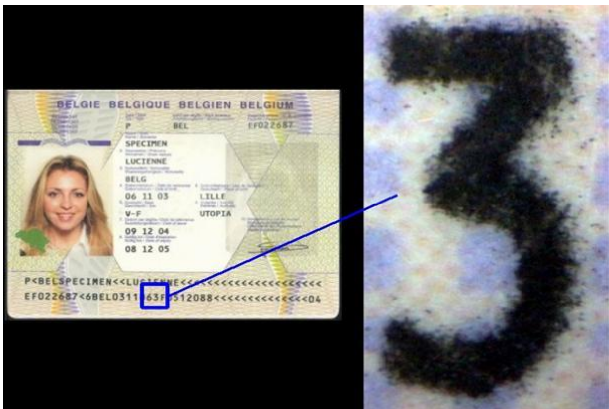
Zone de lecture automatique - procédé d'intégration: impression laser
