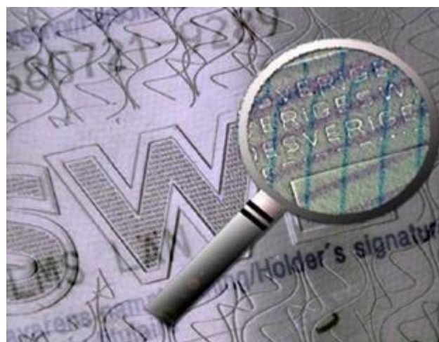
Gaufrage du film de sécurité comportant du texte en micro impression
