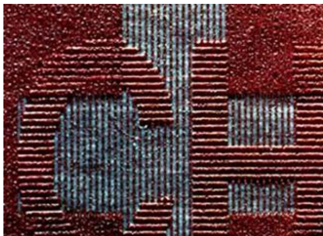
Structure linéaire (à 90°) de l'image latente
