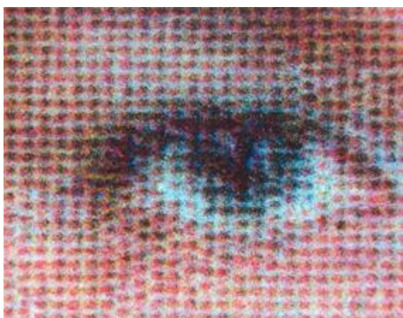
Procédé d'intégration des données biographiques et de la photo: impression laser
