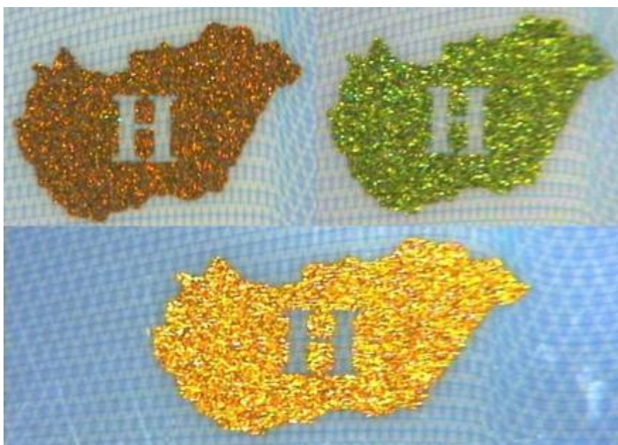
Encre optiquement variable appliquée par sérigraphie
