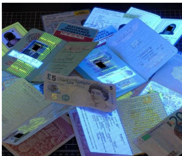
Sous exposition aux UV, des (parties de) documents contrefaits réagissent (luisent) de manière plus brillante.
