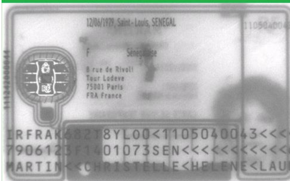
Chip a contatto e chip senza contatto e antenna a telaio di forma speciale nella tessera in policarbonato visibili alla ➡ luce trasmessa .
