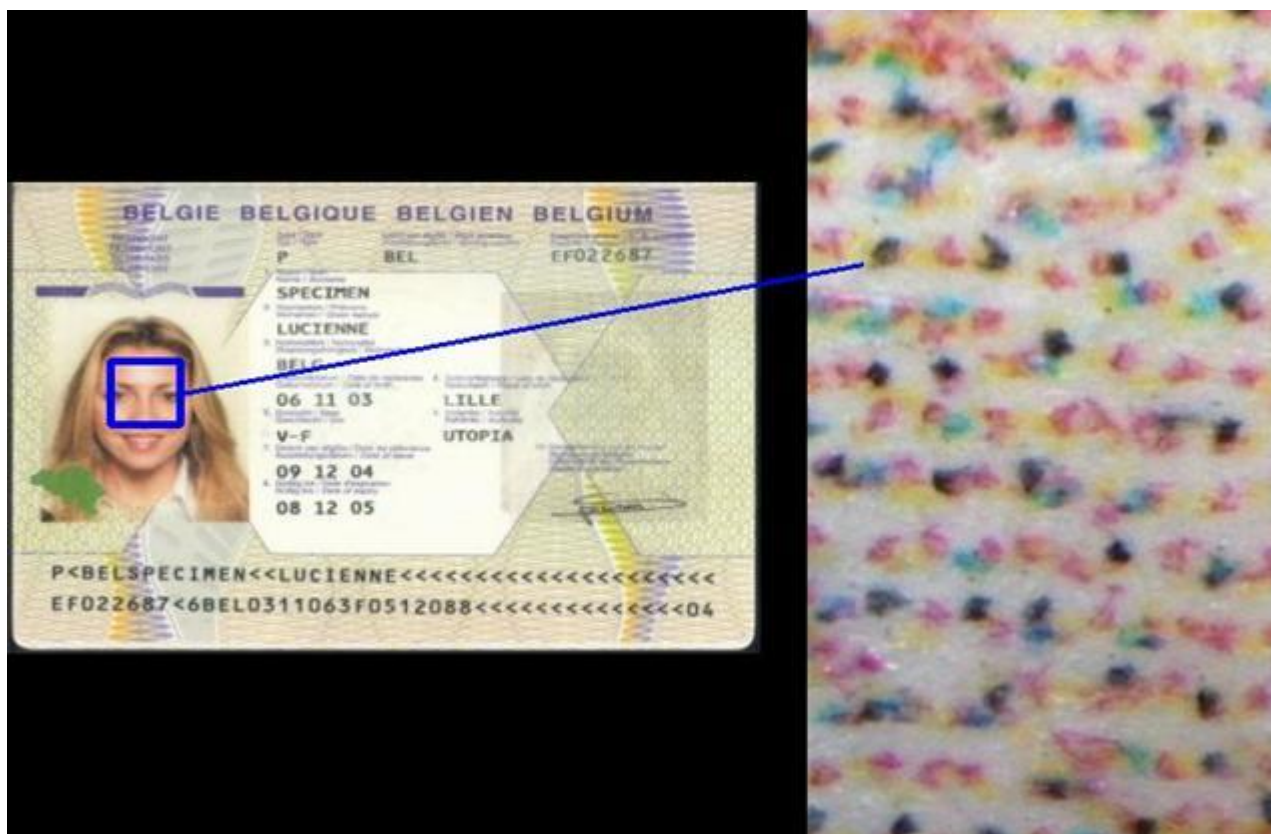
Integrazione di dati anagrafici e fotografia con stampa a getto d'inchiostro
