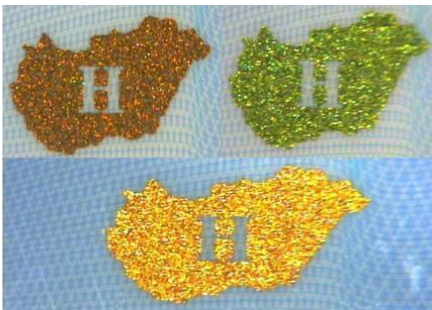
OVI applicato mediante serigrafia
