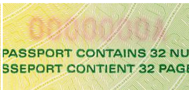
Parte dell'inchiostro usato per la numerazione ha attraversato il supporto cartaceo e risulta visibile sul retro
