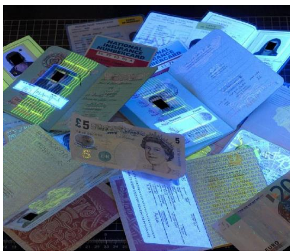
RAGGI UV: i documenti contraffatti e le parti di documento contraffatte emettono fluorescenza (brillano) più intensamente
