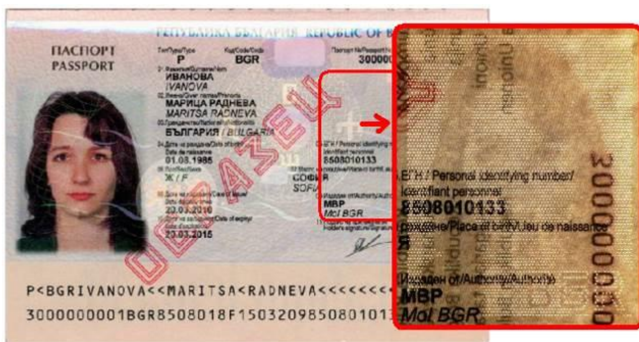
Fotografia secondaria (fantasma) perforata al laser sotto luce trasmessa (lato destro)
