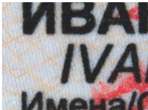
Tecnica di integrazione di dati anagrafici e fotografia: stampa laser
