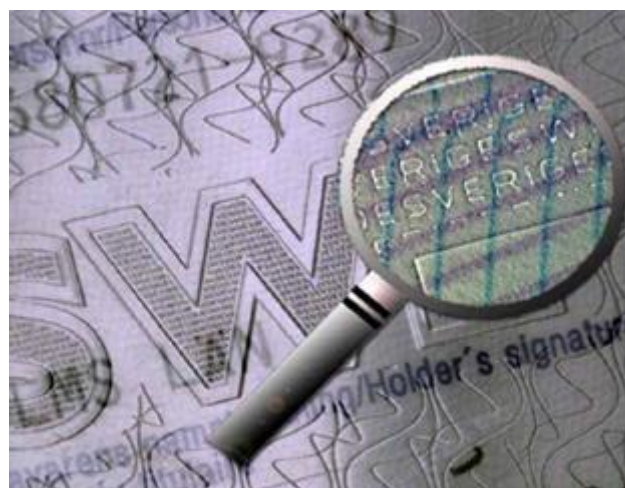
Goffratura della pellicola di sicurezza con microstampa
