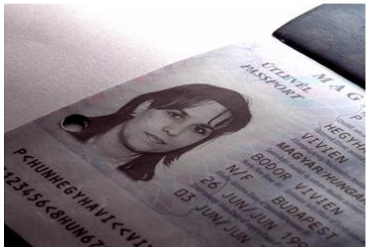
Fotografia integrata mediante incisione laser
