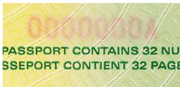
Daļēji numura iespiedkrāsa ir izsūkusies cauri papīram, un ir redzama otrā pusē
