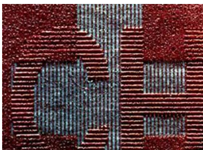
Atkarībā no skata leņķa slīpi krītošā gaismā burti "RP" ir gaiši vai tumši
