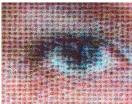
Biogrāfijas datu un fotoattēlu iestrādes paņēmiens – lāzerdruka
