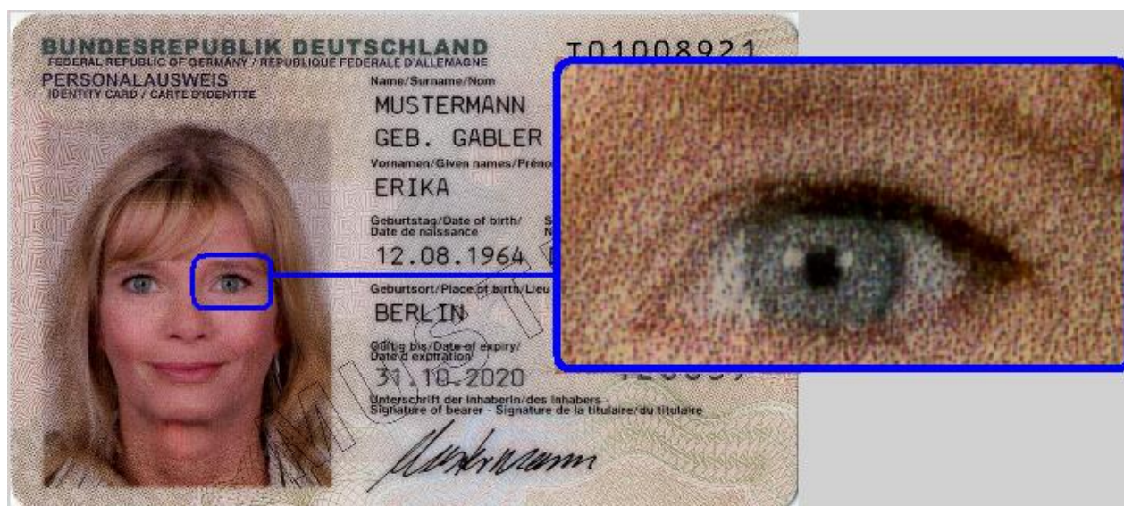
Fotoattēla iestrāde polikarbonāta kartē ( Innosec Fusion process)
