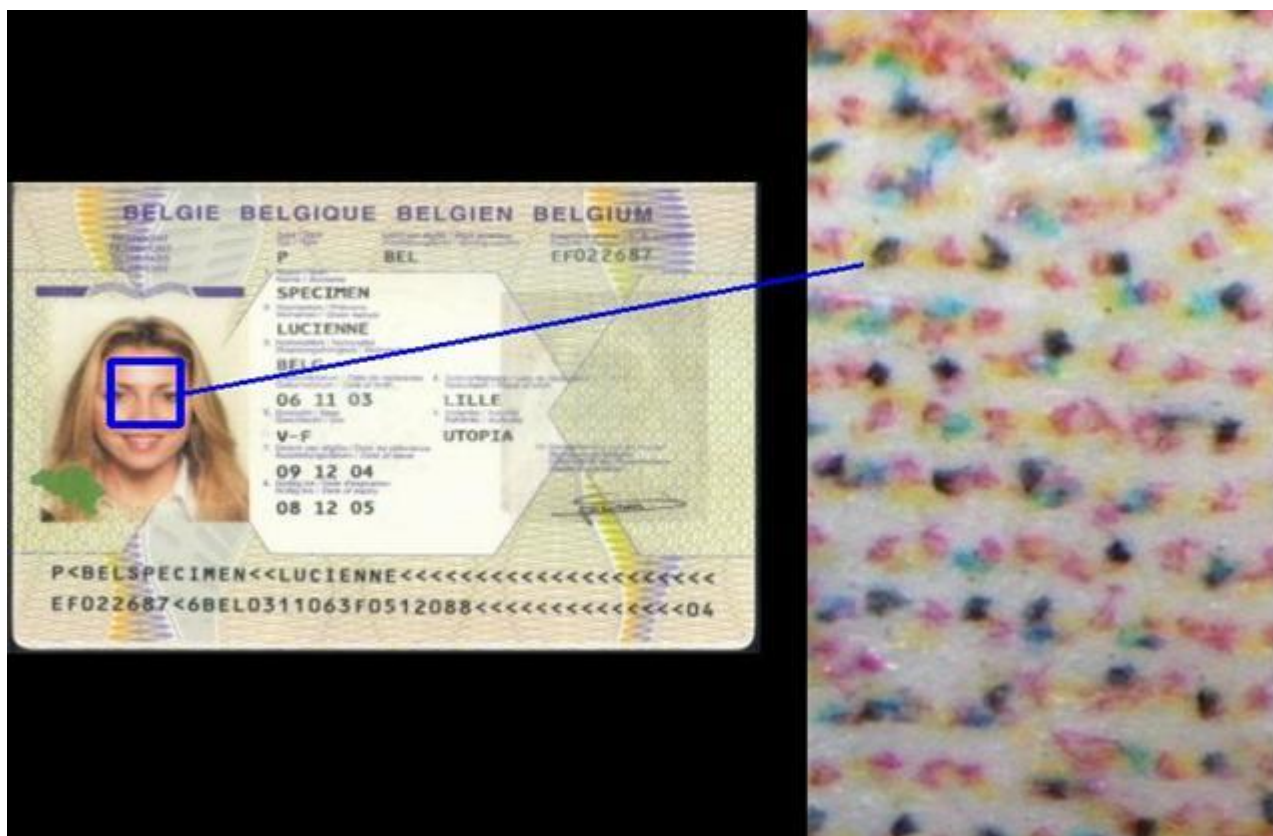
Biogrāfijas datu un fotoattēlu iestrāde, izmantojot strūkļas printeri
