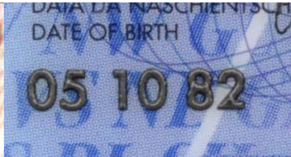
Taustāms lāzergravēts dzimšanas datums
