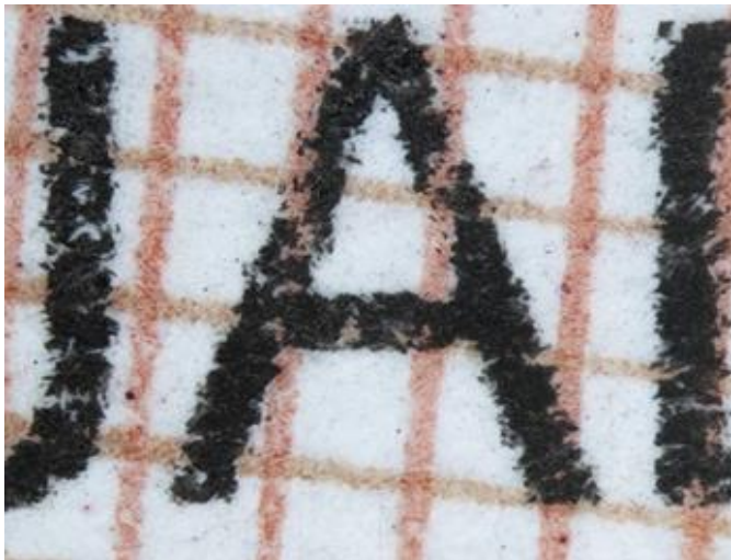
Biogrāfijas datu/fotoattēlu iestrāde, izmantojot druku ar strūklas printeri
