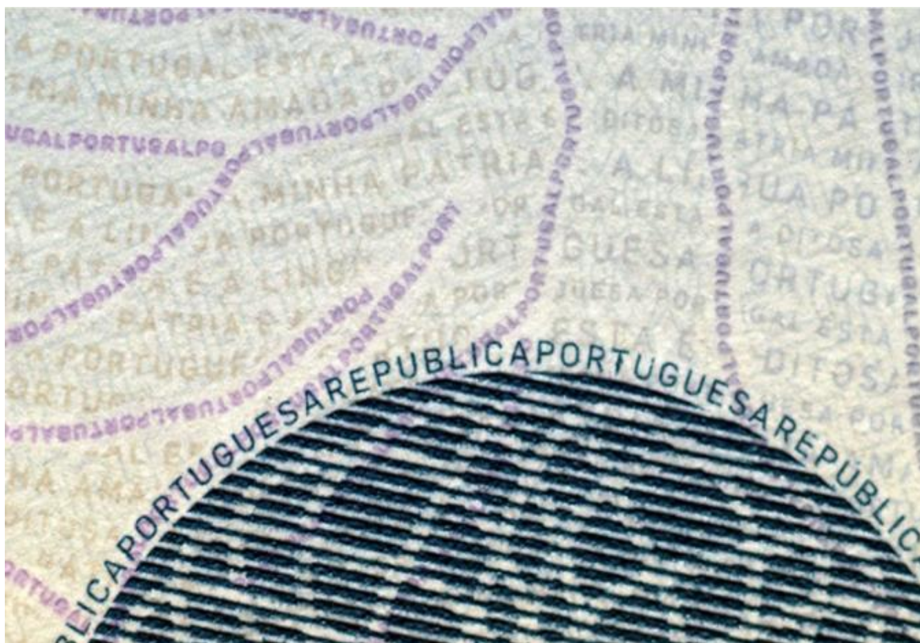
Minidruka (ziliem burtiem) un mikrodruka (sīkiem, violetiem burtiem)
