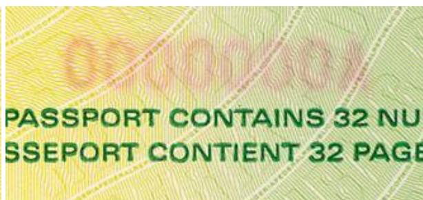
Een deel van de inkt die voor het serienummer is gebruikt, is door het papieren basismateriaal gedrongen en wordt zichtbaar aan de andere zijde.
