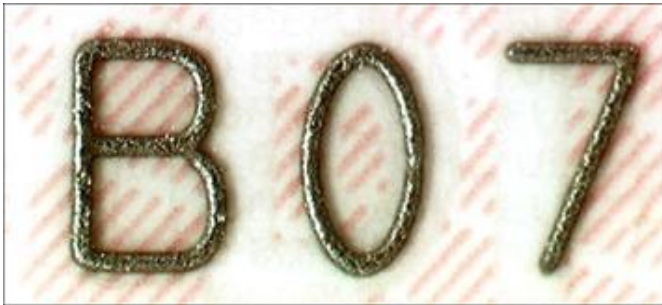
Voelbare lasergraving van de nummering
