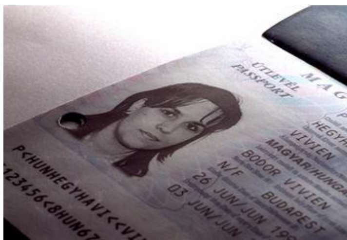
Door middel van lasergraving geïntegreerde afbeelding
