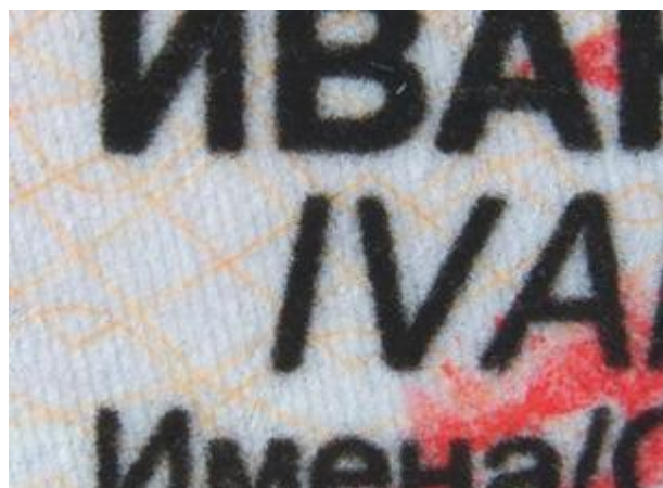
Integratietechniek voor persoonsgegevens en foto: laserprint
