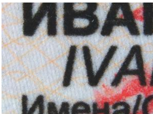
Técnica de integração dos dados biográficos e da fotografia: impressão a laser
