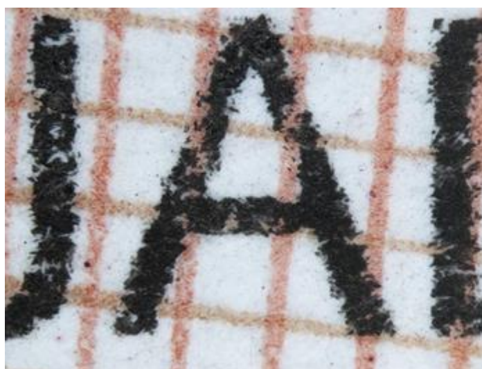
Integração dos dados biográficos/da fotografia pela técnica de impressão a jato de tinta
