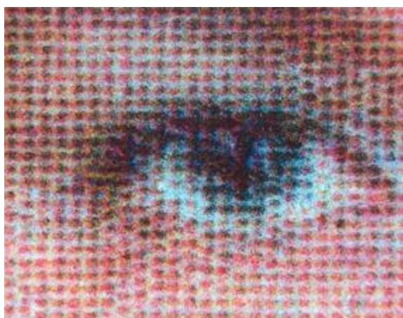
Técnica de integração dos dados biográficos e da fotografia: impressão a laser
