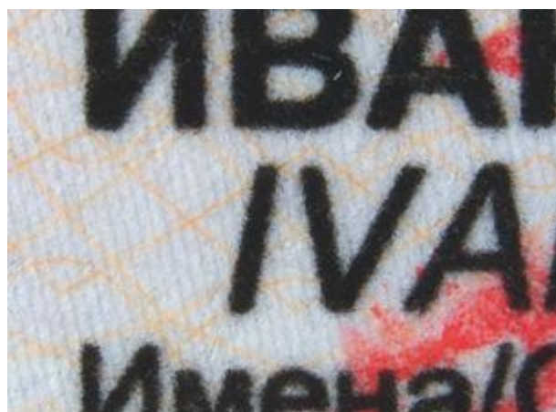
Technika integrování osobních údajů a fotografie: laserový tisk
