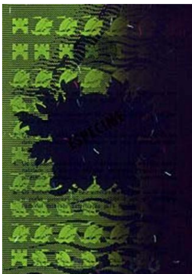
Tatáž strana v UV světle – fluorescentní barva; hnědá barva podtisku fluoreskuje zeleně.
