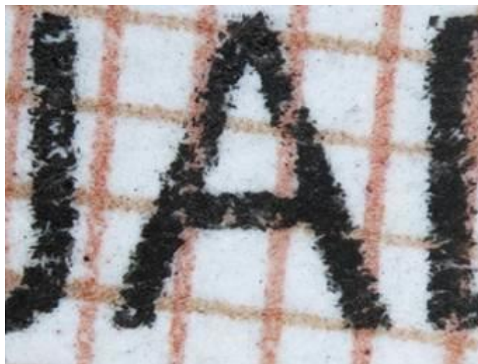
Integrování osobních údajů / fotografie technikou inkoustového tisku
