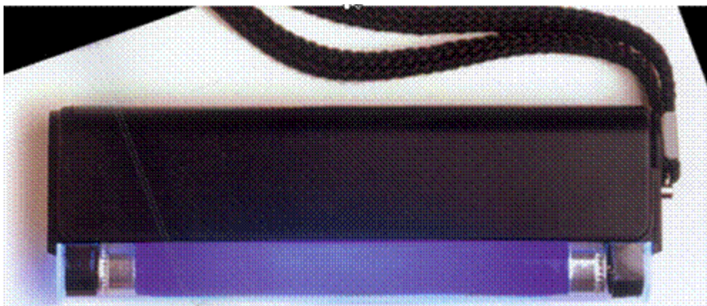
Jednoduché příruční UV světlo pro zkoumání dokladů
