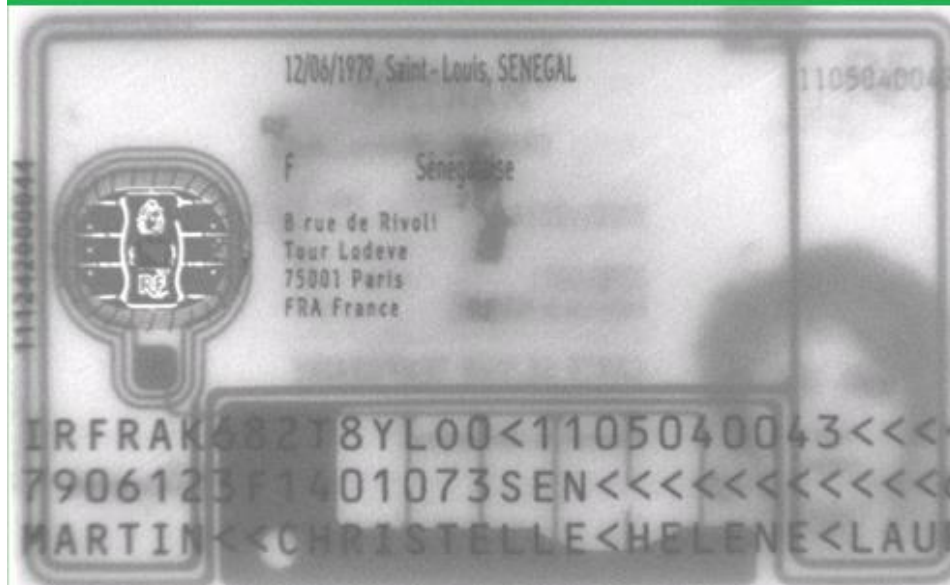
Kontaktní čip a bezkontaktní čip a speciálně tvarovaná rámová anténa v polykarbonátové kartě jsou viditelné v ➡ průchozím světle.
