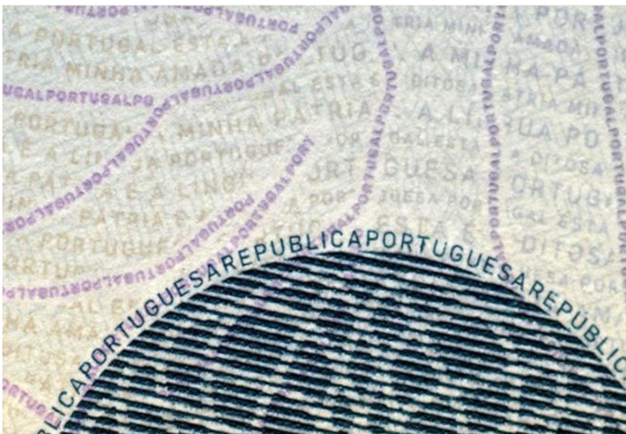
Minitisk (modrý text) a mikrotisk (menší fialová písmena)
