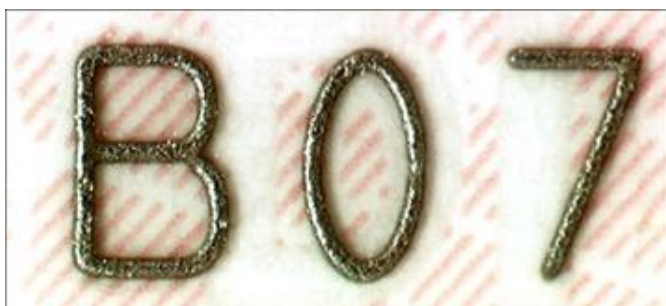
Hmatatelné laserové gravírování čísla
