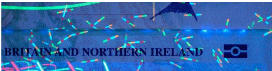
Vícebarevná fluorescentní melírovací vlákna
