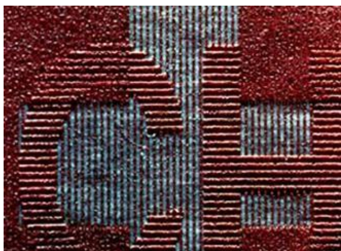
Struktura (90°) skrytého obrazce tvořená čarami
