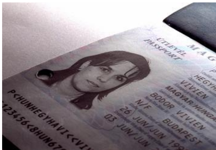
Fotografie integrovaná laserovým gravírováním
