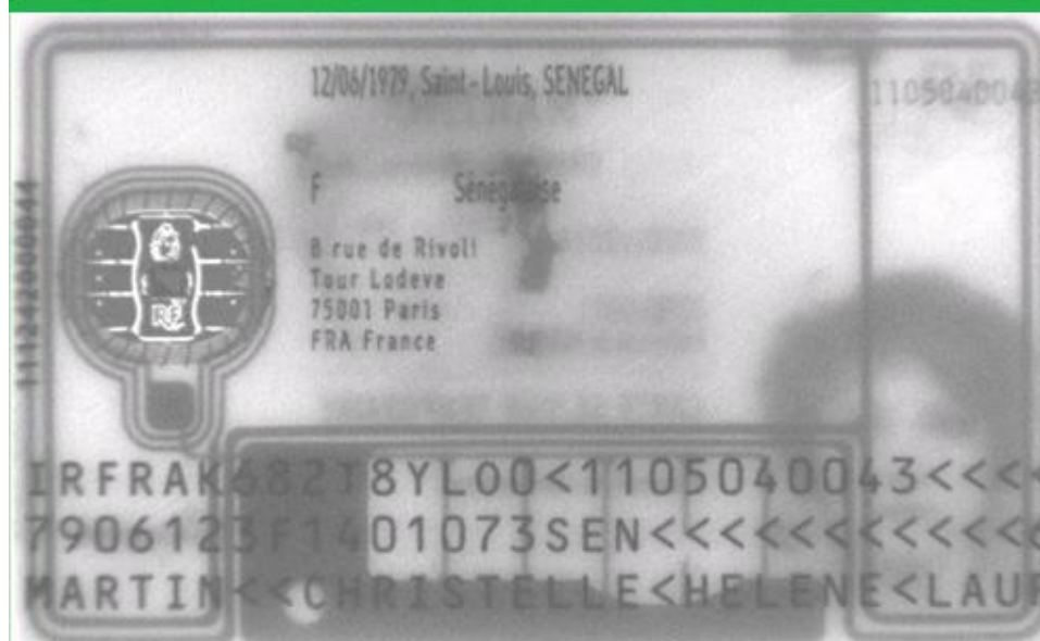
Το μικροκύκλωμα επαφής και το μικροκύκλωμα χωρίς επαφή καθώς και η ειδικά προσαρμοσμένη βροχοκεραία στην κάρτα από πολυανθρακικό πολυμερές είναι ορατά με ➡ όπισθεν φωτισμό.
