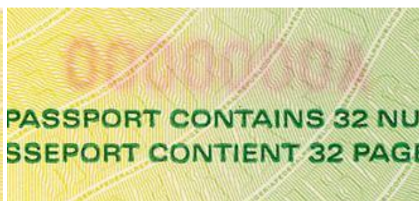
Ένα μέρος της μελάνης που έχει χρησιμοποιηθεί για την αρίθμηση έχει διαπεράσει το χάρτινο υπόστρωμα και φαίνεται και από την πίσω όψη.
