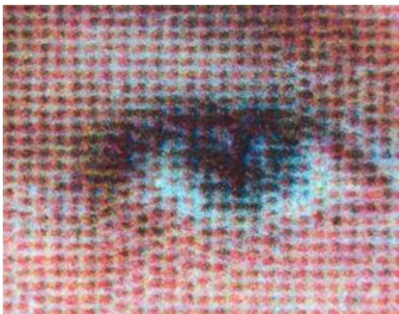
Τεχνική ενσωμάτωσης στοιχείων κατόχου και φωτογραφίας: εκτύπωση με λέιζερ
