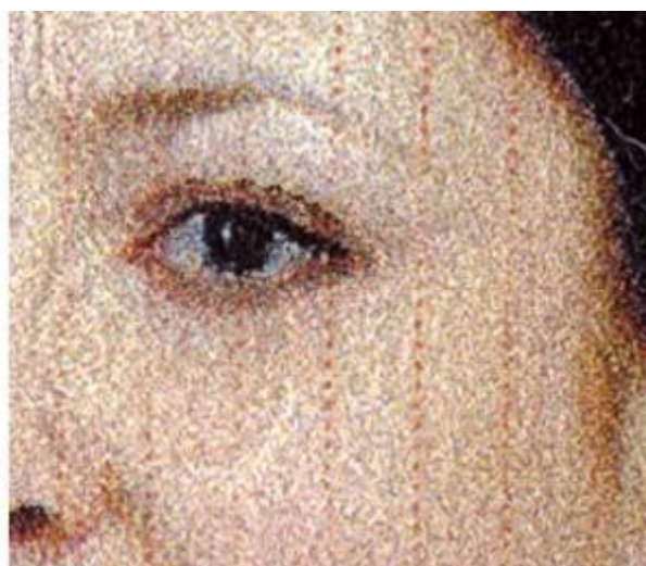
Ενσωμάτωση στοιχείων κατόχου / φωτογραφίας με την τεχνική της εκτύπωσης με ψεκασμό μελάνης
