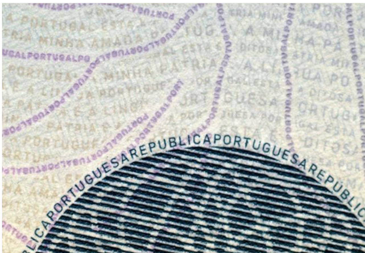
Μινιεκτύπωση (τα μπλε γράμματα) και μικροεκτύπωση (τα μικρότερα μωβ γράμματα)
