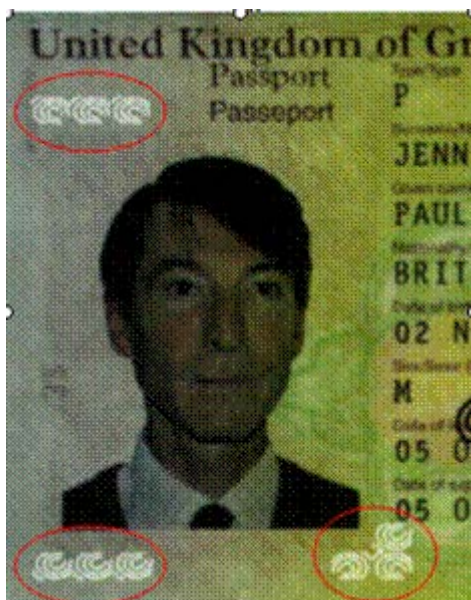
Δομές/σχήματα με διάτρηση με λέιζερ (εντομές): Destri Perf®
