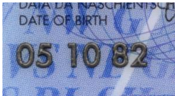
Ψηλαφητή εγχάραξη της ημερομηνίας γέννησης με λέιζερ
