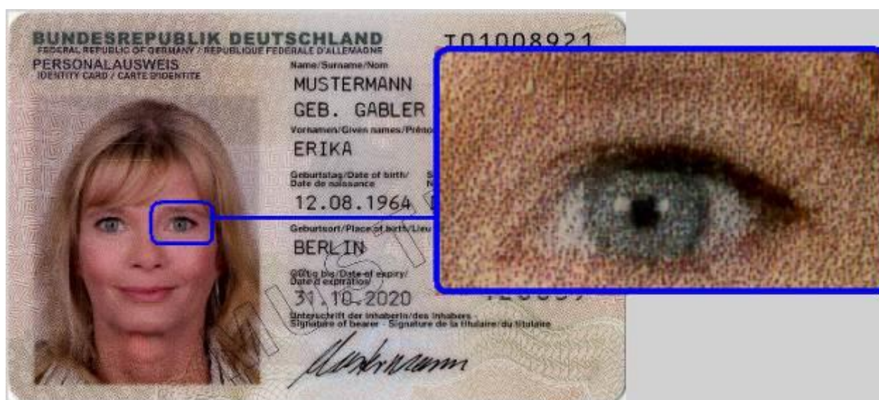
Δελτίο ταυτότητας: ενσωμάτωση φωτογραφίας στην κάρτα από πολυανθρακικό πολυμερές (διαδικασία Innosec Fusion)
