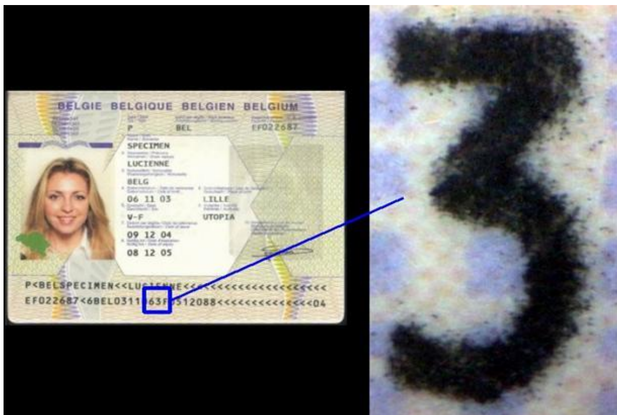
MRZ - Τεχνική ενσωμάτωσης: εκτύπωση με λέιζερ
