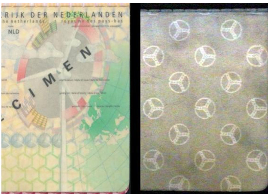
Κανονικός φωτισμός (αριστερά) και όψη υπό ομοαξονικό φωτισμό (δεξιά)
