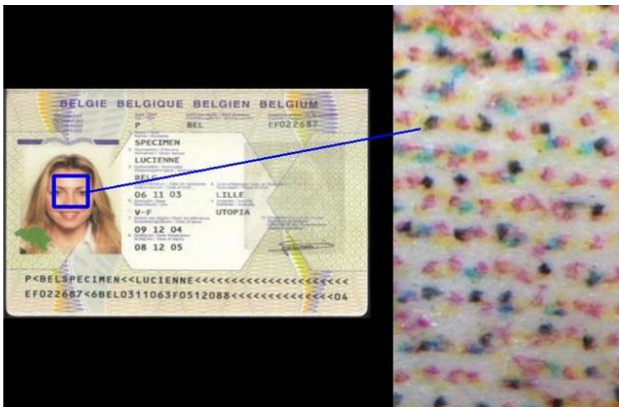
Ενσωμάτωση στοιχείων κατόχου και φωτογραφίας με ψεκασμό μελάνης
