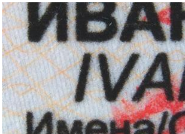
Τεχνική ενσωμάτωσης στοιχείων κατόχου και φωτογραφίας: εκτύπωση με λέιζερ
