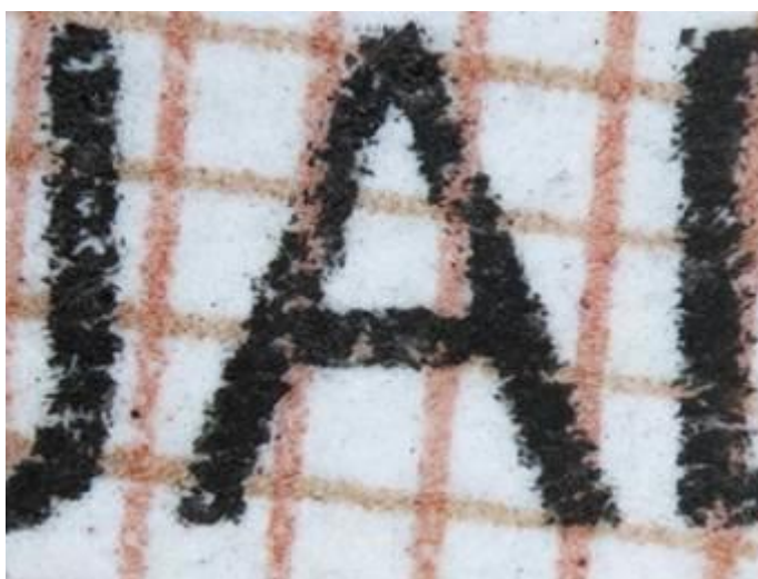
Ενσωμάτωση στοιχείων κατόχου / φωτογραφίας με την τεχνική της εκτύπωσης με ψεκασμό μελάνης
