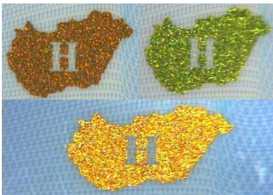
Optički promjenjive tinte otisnute sitotiskom
