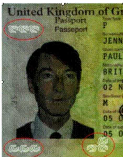
Laserski perforirane strukture/motivi: Destri Perf®
