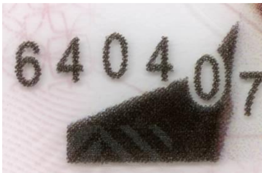
Tehnologija PCP® ( individualizacija polikarbonatnom tintom ).
