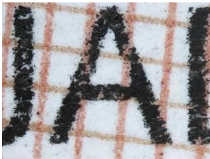
Integracija osobnih podataka / slike upotrebom tehnike tintnog (ink-jet) ispisa
