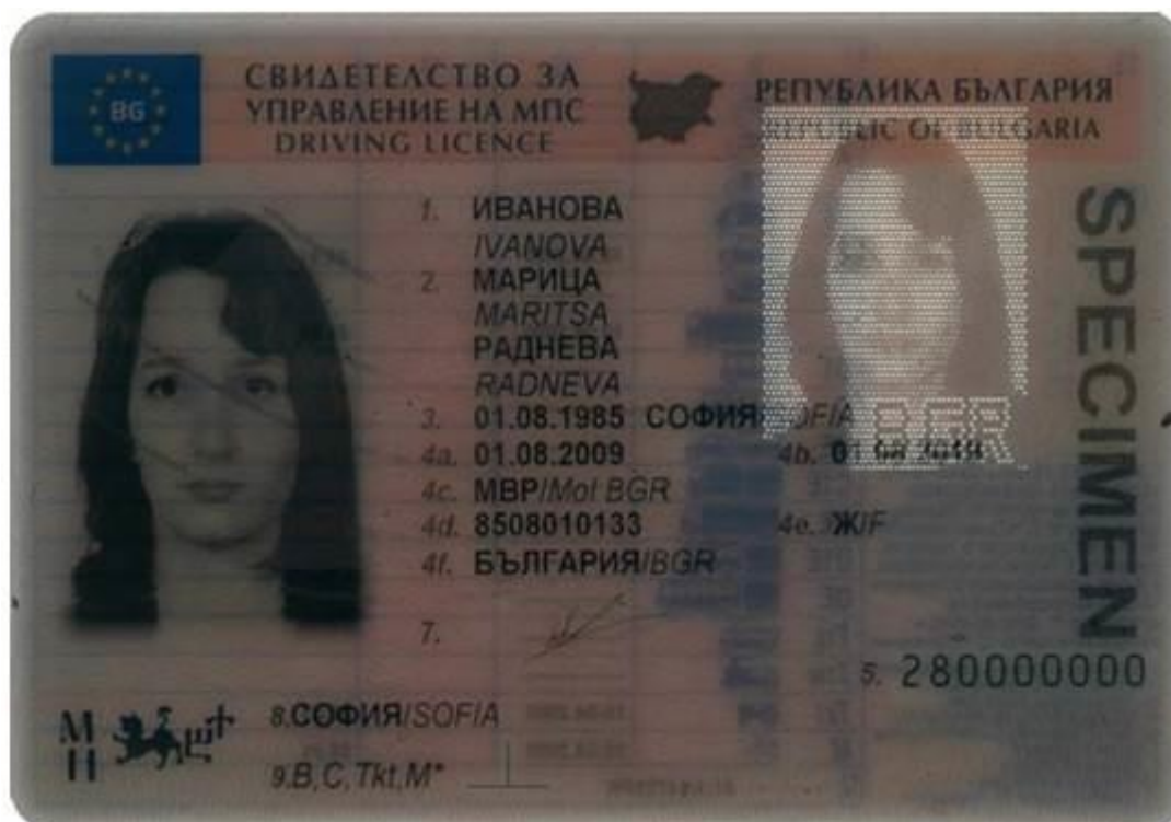
Laserski perforirana sekundarna (ghost) fotografija
