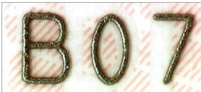
Opipljivo lasersko graviranje brojčanog označavanja
