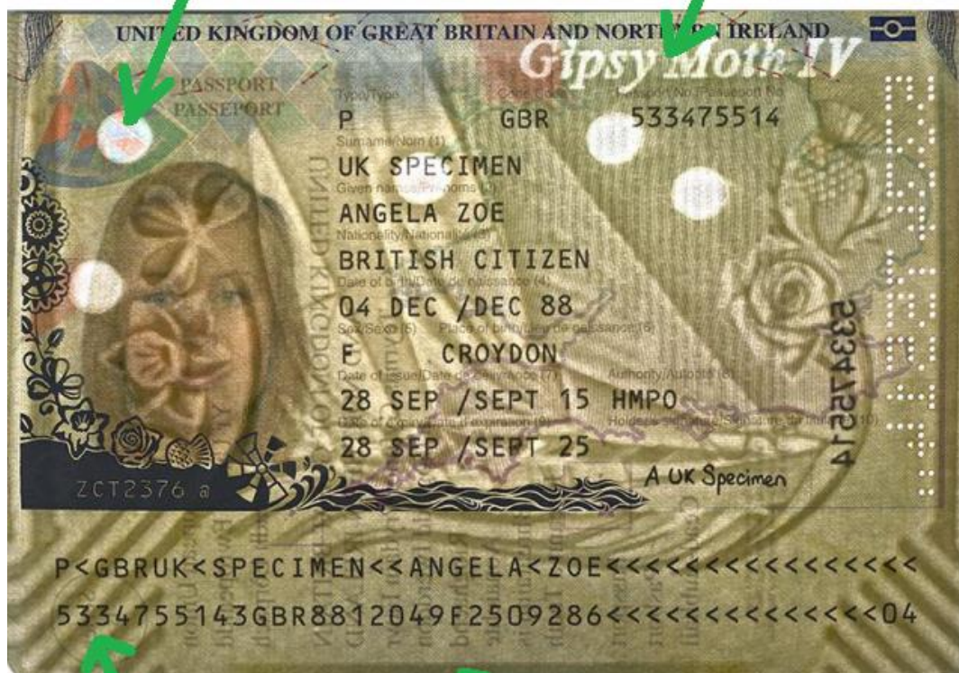
Višetonski vodeni znak izrađen kalupom
