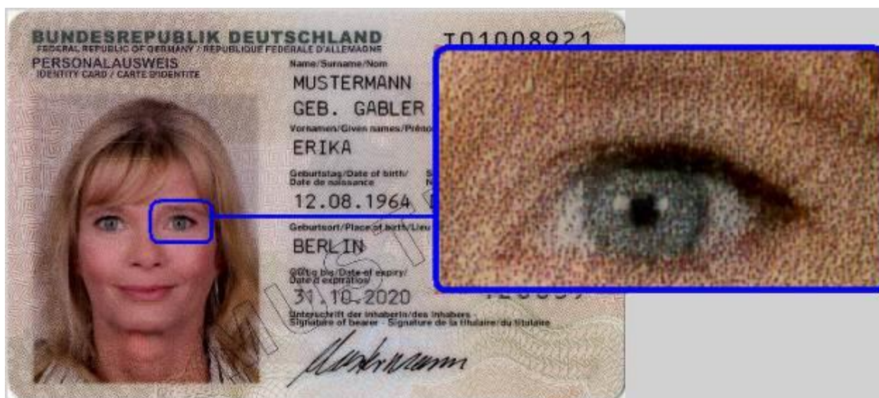
Integracija fotografije u polikarbonatnu karticu (postupak Innosec® Fusion)
