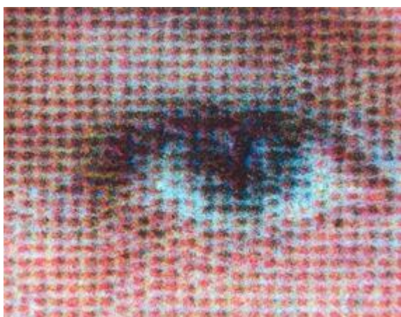
Tehnika integracije osobnih podataka i fotografija: laserski ispis
