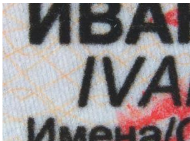
Tehnika integracije osobnih podataka i fotografija: laserski ispis
