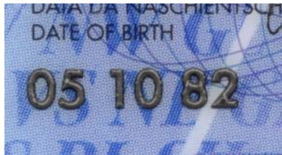
Opipljivo lasersko graviranje datuma rođenja
