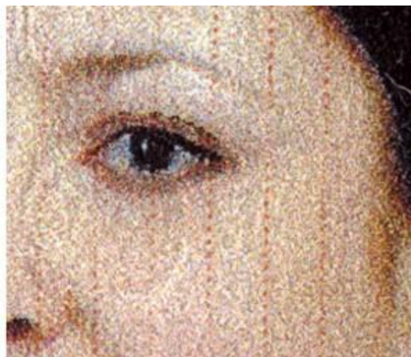
Integracija osobnih podataka / slike upotrebom tehnike tintnog (ink-jet) ispisa
