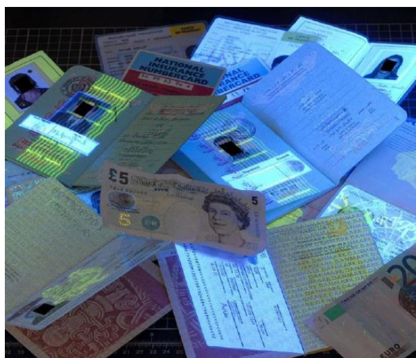
UV SVJETLO: Krivotvoreni (dijelovi) isprava fluoresciraju (svijetle) jače
