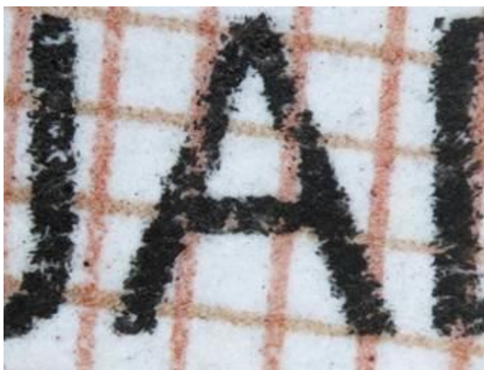
Személyi adatok / fénykép integrálása tintasugaras nyomtatási technika alkalmazásával
