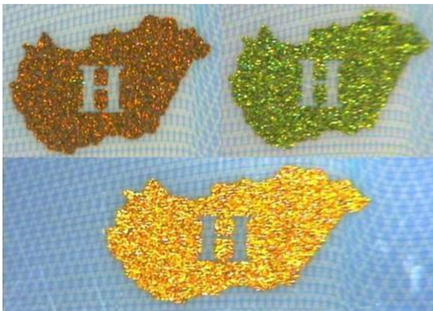
Szitanyomtatással készült OVI
