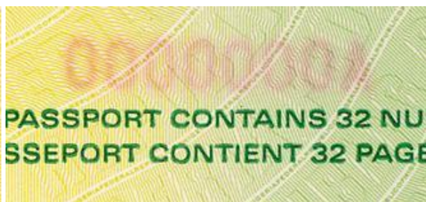
A sorszám nyomtatására használt festék egy része áthatolt a papír-hordozóanyagon, és a hátoldalon is láthatóvá válik.
