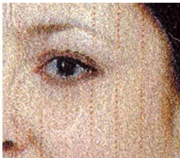
Személyi adatok / fénykép integrálása tintasugaras nyomtatási technika alkalmazásával
