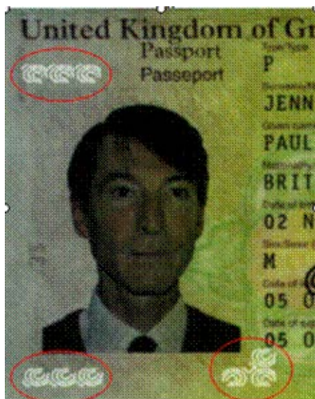
Lézerperforált struktúrák/minták: Destri Perf®
