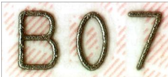
Sorszám tapintható lézergravírozása
