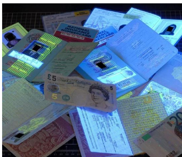
UV-fény Az utánzott okmányok, illetve az utánzott okmányrészek fényesebben fluoreszkálnak.
