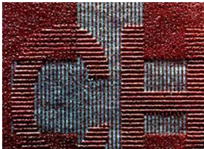
A látens kép vonalstruktúrája (90°)
