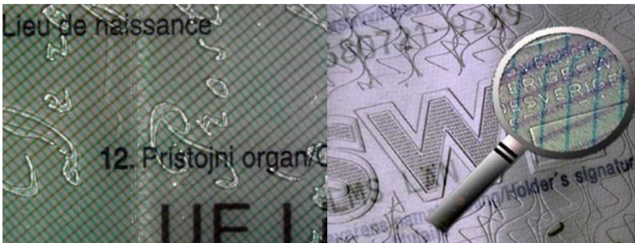
Dombornyomott fólia mikronyomtatással
