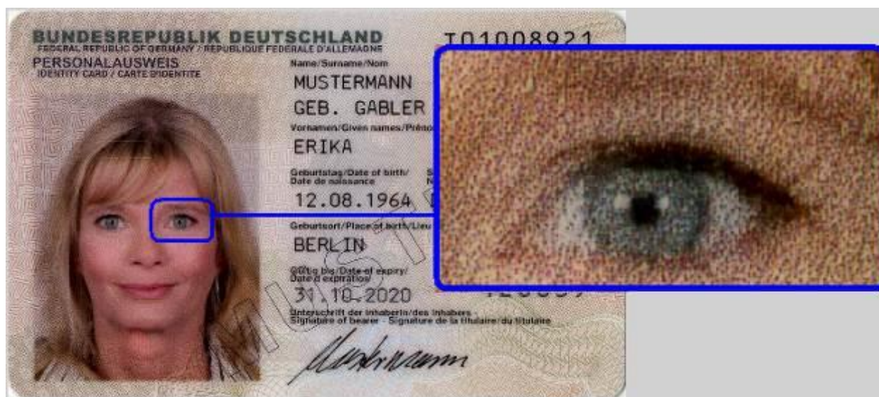
Fénykép integrálása a polikarbonát kártyába (Innosec Fusion eljárással)
