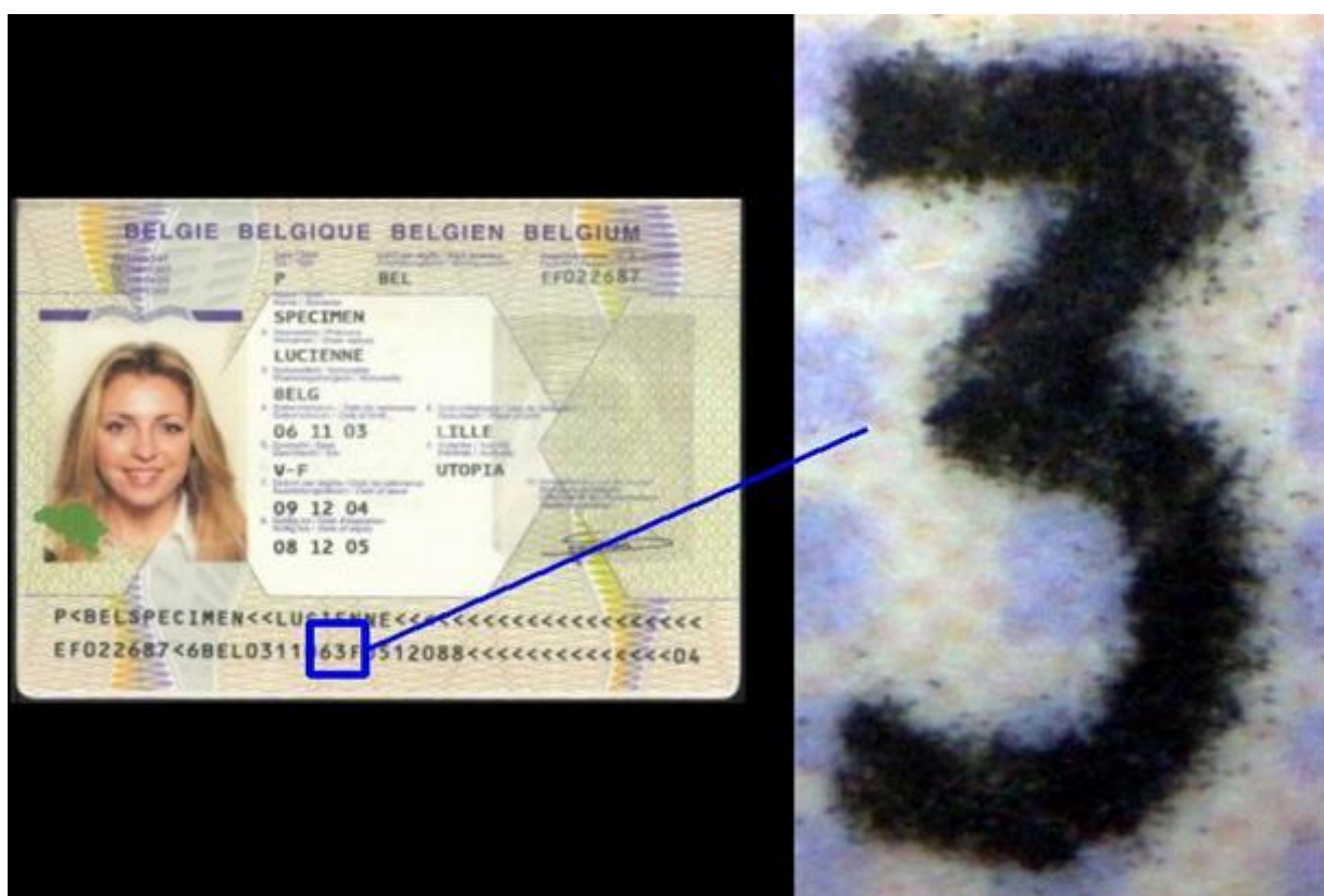
MRZ – integrálási technika: lézernyomtatás
