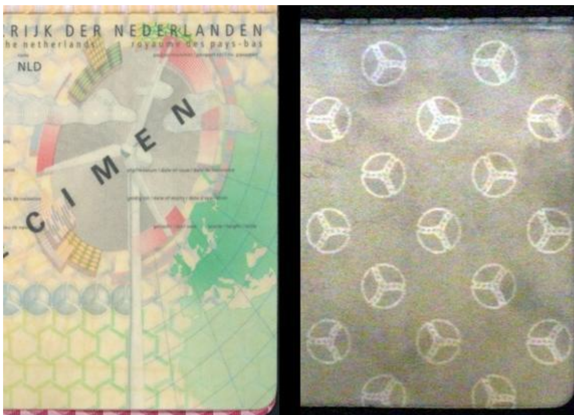
Normál fényben (a bal oldalon) és koaxiális fényben látható kép (a jobb oldalon)
