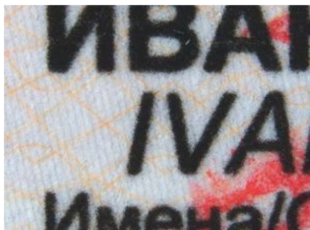
Személyi adatok és fénykép integrálási technikája: lézernyomtatás
