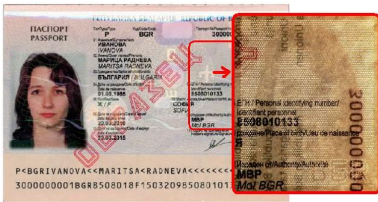
Lézerperforált másodlagos kép (szellemkép) áteső fényben (a jobb oldalon)
